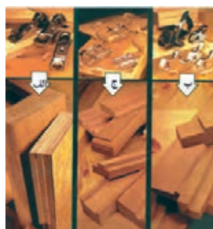
شکل ۶-۲۱. سه گروه رنده‌ی مورد استفاده در کارهای صنایع چوب.
