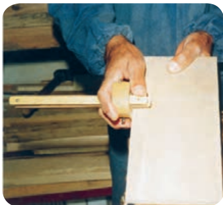
شکل ۶-۷۷. فماتکشی روی چوب با فماتکش تیره‌دار.
