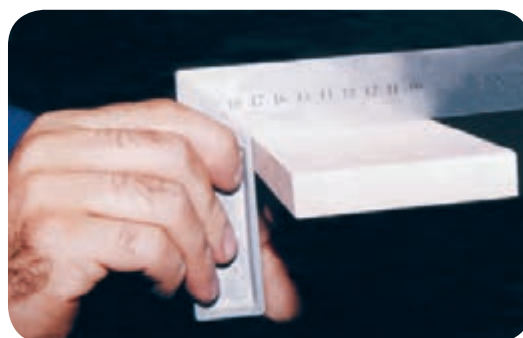
شکل ۶-۷۴. آزمایش صمت رنده‌کاری با گونیا
