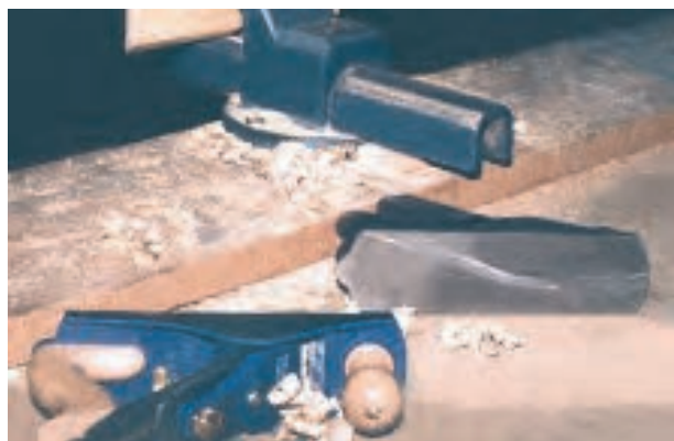
شکل ۶-۹۱- قرار دادن رنده در گودی میز کار.
