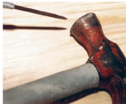
شکل ۷-۳۹- پلیسه‌ی ایجاد شده در سر چکش.
