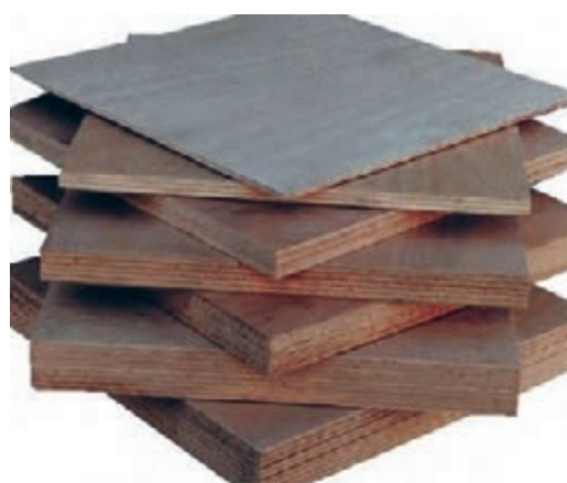
شکل ۳-۴۸ - انواع تخته پندلایه، با ضخامت های متفاوت.
