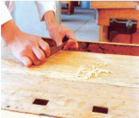
شکل ۲-۱۷- تمیز کردن سطح میز کار با لیسه.
