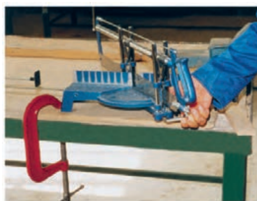
شکل ۵-۶۳- قرار دادن ارّه روی زاویه‌ی موردنظر به کمک اهرم تنظیم.
