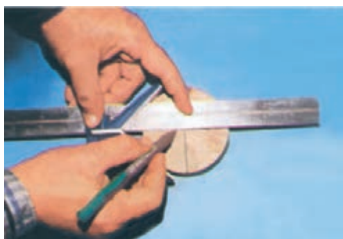
شکل ۶-۱۰۷- استفاده از قطعه‌ی مرکز‌یاب.
