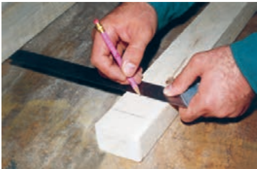
شکل ۵-۴۸- فم‌کشی قطعه کار به وسیله‌ی گونیا و مداد.
