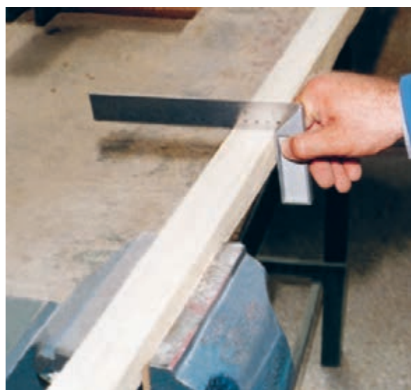
شکل ۶-۸۵- صمت گونیایی بودن قطعه کار با گونیا.
