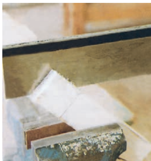
شکل ۵-۵۵. مالت افقی ارّه در پایان برش.
