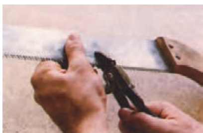
شکل ۱۴-۵۴- فم کردن بقیه دندانها به طرف پایین.
