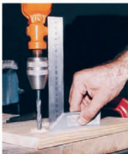
شکل ۱۲-۴۷- آزمایش گونمایی قرار گرفتن دریل.
