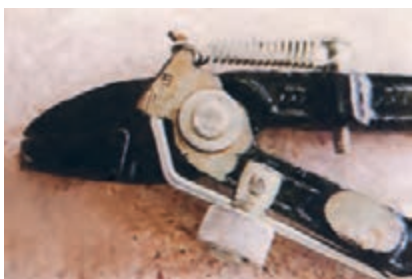
شکل ۱۴-۵۵- تنظیم انبر چپ و راست کن با پیچ‌های مفصوص.
