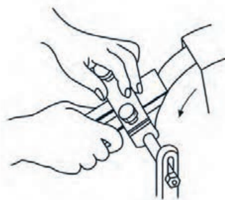
شکل ۱۴-۲۴- تیزکردن تیغه (رنده با سنگ سنباده).
