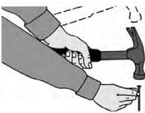
شکل ۷-۳۱- نمونه‌ی گرفتن میخ هنگام کوبیدن.
