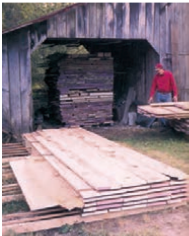
شکل ۳-۴۰. هانگار چوب فشک‌کنی.
