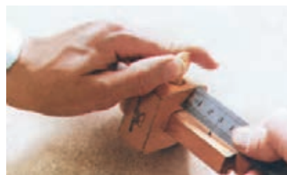
شکل ۶-۷۶. تنظیم فماتکش تیره‌دار.
