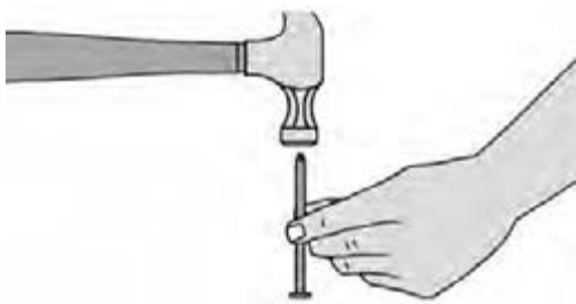
شکل ۷-۳۰- کند کردن تیزی سر میخ.
