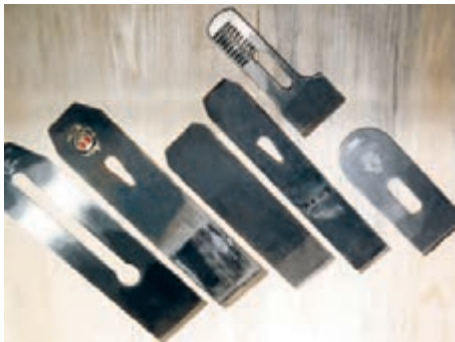
شکل ۹-۱۱- بدنه‌ی تیغه از جنس فولاد، و لبه‌ی برنده‌ی آنها، از فولاد آلیاژی است.
