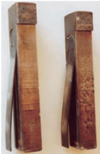
شکل ۲-۹- آهن نگهدارنده‌ی قطعه کار.
