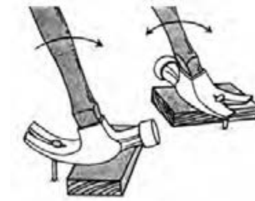
شکل ۷-۳۸- استفاده از چکش میخ کش برای بیرون کشیدن میخ.
