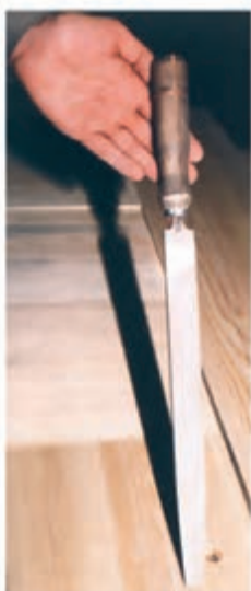
شکل ۱۱-۲۲. دسته‌ی شکسته‌ی چوب‌سا و سوهان را تعویض کنید.
