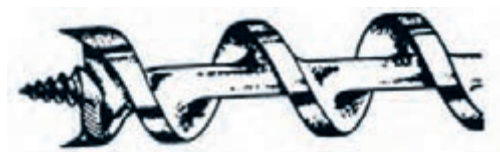
شکل ۱۲-۲۳- سر مته‌ی مدل ابروین.
