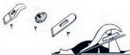
شکل ۶-۶۱- قسمت‌های تفکیک شده رنده کله چوب شامل:
