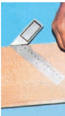
شکل ۶-۱۰۴ خط‌کشی خطوط ۴۵ درجه به وسیله‌ی گونیای معمولی.
