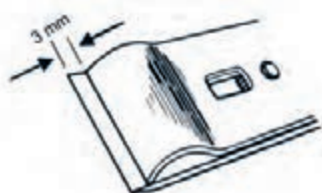
شکل ۶-۷- نمونه‌ی قرار گرفتن پشتی (روی تیغه).
