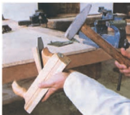
شکل ۶-۱۵- رعایت اصول ایمنی، هنگام فارغ کردن تیغه رنده.
