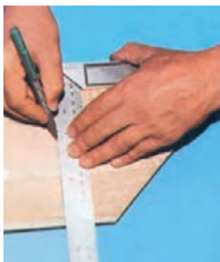
شکل ۶-۱۰۳ استفاده از گونیا برای خط‌کشی.
