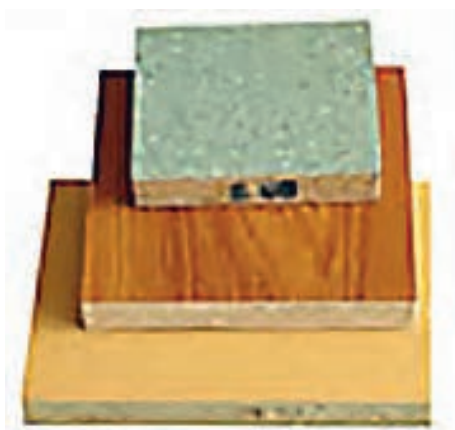
شکل ۳-۴۶. تخته فرده چوب با روکش مصنوعی.
