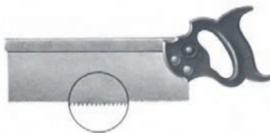
شکل ۵-۹- اره پشت‌دار، با بزرگنمایی دندان‌ها.
