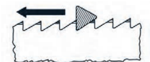
شکل ۱۴-۵۹. جهت تیزکردن به وسیله سوهان.
