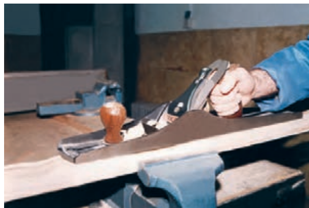
شکل ۶-۸۴- استقرار رنده بلند (دستگاه).
