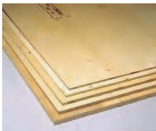
شکل ۳-۴۷. تخته فرده چوب با روکش طبیعی.
