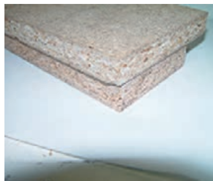
شکل ۳-۴۵. تخته فرده چوب با لایه‌های تدریجی.
