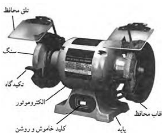
شکل ۱۲-۱۴. قسمت‌های مختلف سنگ سنباده.
