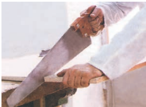
شکل ۵-۸- نمونه‌ی برش به وسیله ارّه دُم روباهی.
