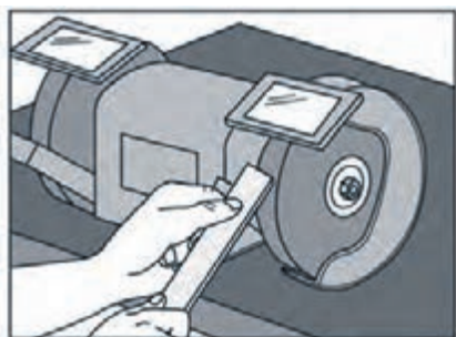
شکل ۱۴-۴۶ حرکت دادن تیغه روی سنگ سنباده.
