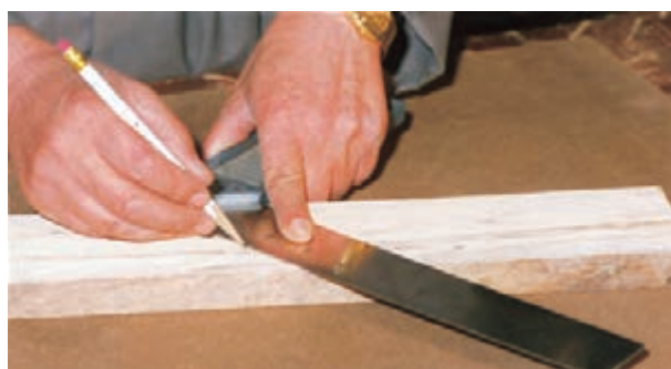
شکل ۶-۹۳- کار کردن با گونیای فارسی.
