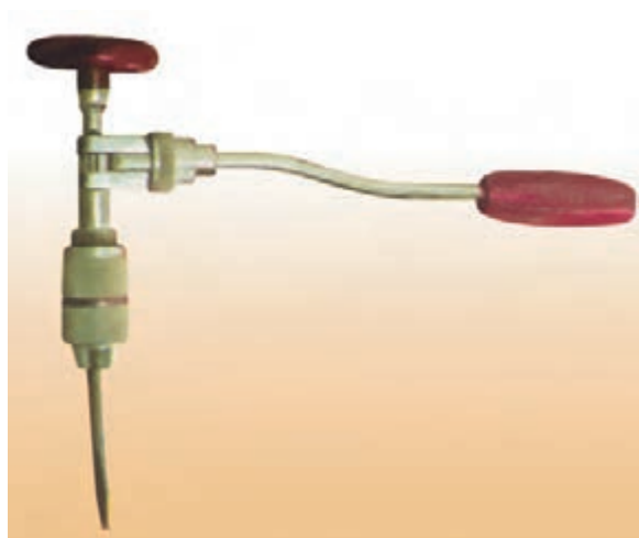
شکل ۱۲-۲- دریل شتر گلو، مخصوص گوشه کار.
