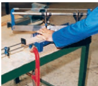
شکل ۵-۶۴- ایجاد برش ۴۵ درجه به وسیله‌ی ارّه فارسی‌بُر.
