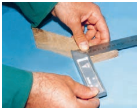
شکل ۵-۶۵- کنترل گونیایی بودن قطعه کار.
