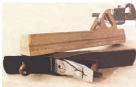
شکل ۴۹-۶- رنده بلند (دستگاه).
