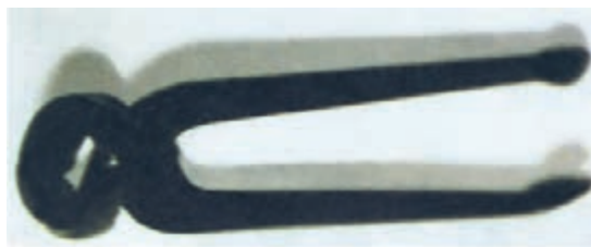
شکل ۷-۲. گاز انبر میخ کش.
