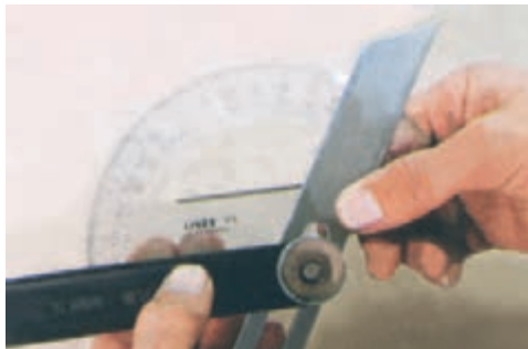
شکل ۱۰۰-۶. استفاده از نقاله در گونیا‌ی تاشو.
