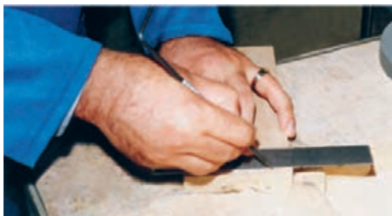
شکل ۶-۸۶- خط‌کشی با استفاده از گونیا.
