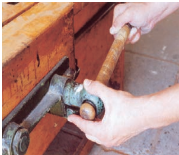
شکل ۲-۱۸- ضامن باز و بسته کردن آزاد گیره.
