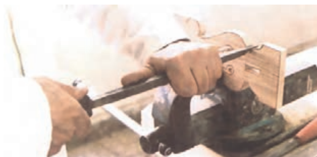
شکل ۱۱-۱۴- کاربرد سوهان چهار گوش.
