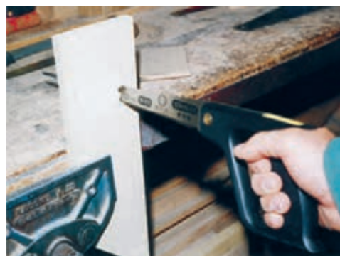
شکل ۵-۵۹- نمونه‌ی ایجاد سوراخ به وسیله‌ی اره نوکی.
