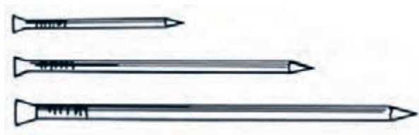
شکل ۷-۱۳- میخ گرد با سر خزینه‌ای.
