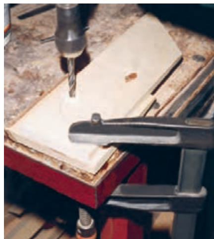
شکل ۵-۵۸- ایجاد سوراخ در قسمت داخلی قطعه کار.
