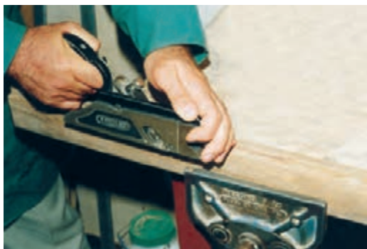
شکل ۶-۷۹. به کارگیری رنده بغل بدون گونیا.
