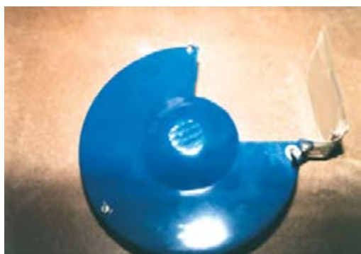
شکل ۱۳-۱۴. قاب محافظ سنگ سنباده.
