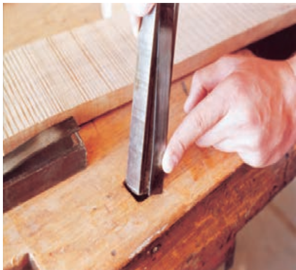
شکل ۲-۲۰- نمونه‌ی استقرار آهن نگهدارنده‌ی قطعه کار.
