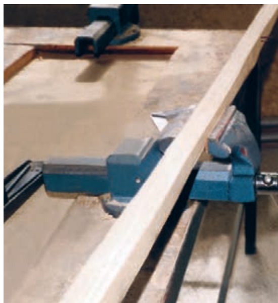
شکل ۶-۸۳- بستن قطعه کار به گیره میز کار.
