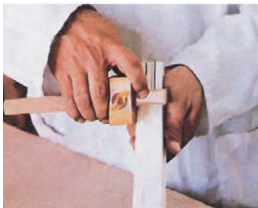
شکل ۵-۵۴. فکاشی با استفاده از فکاش تیزه‌دار.
