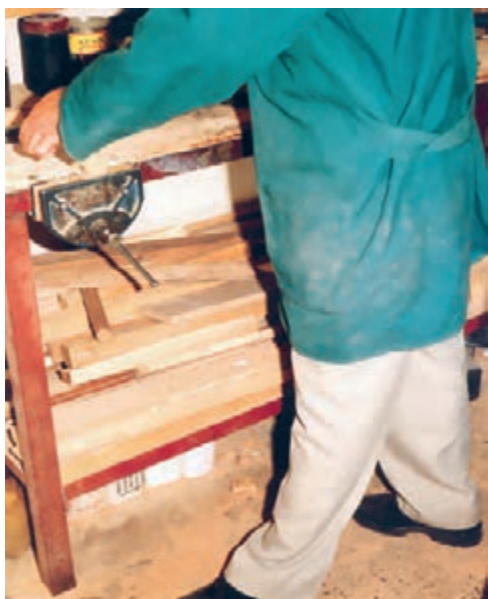
شکل ۱۱-۲۷. طرز صمیع ایستادن هنگام استفاده از چوب‌سا و سوهان.
