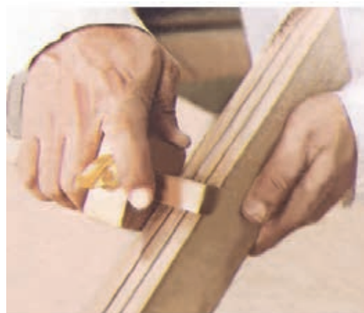
شکل ۶-۸۱- فم‌کشی با فم‌کش تیره‌دار.
