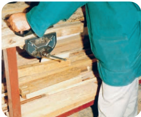
شکل ۶-۷۳ نمونه‌ی ایستادن هنگام رنده‌کاری.
