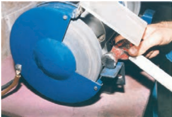
شکل ۷-۴۰- گرفتن پلیسه به وسیله‌ی سنگ سنباده.
