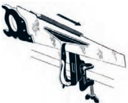
شکل ۱۴-۶۲. میزان کردن دندان‌های اره به وسیله سوهان.
