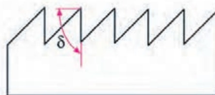
شکل ۵-۳۲- زاویه‌ی برش \delta مساوی ۹۰ درجه.
