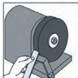
شکل ۱۴-۴۴ تنظیم تکیه‌گاه سنگ سنباده.
