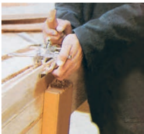
شکل ۶-۸۲- چگونگی کار با رنده کنشکاف.
