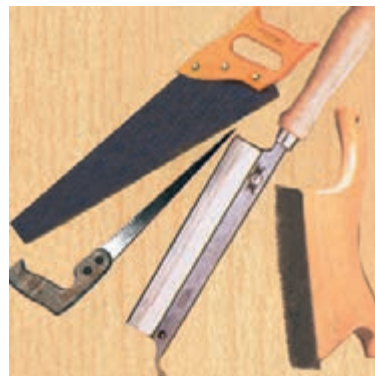
شکل ۵-۱- چند نوع از اره‌های دستی.
