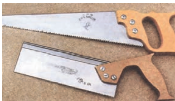
شکل ۵-۲- اره‌های دندانه‌رو به جلو.
