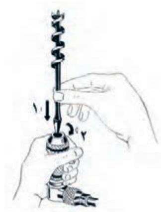
شکل ۱۲-۳۵- بستن سر مته به دریل.
