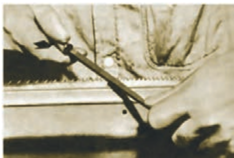
شکل ۱۴-۲۲- تیزکردن اره با استفاده از سوهان.
