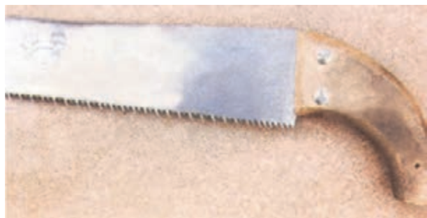
شکل ۵-۳- اره‌ی دندانه‌رو به عقب.
