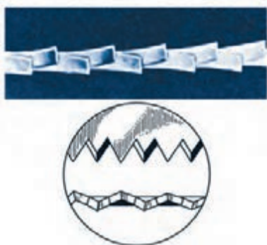
شکل ۱۷-۱۴- دندانه‌های چپ و راست شده.
