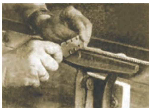
شکل ۱۴-۵۲- چپ و راست کردن ارّه با آهن چپ و راست کن.
