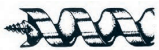
شکل ۱۲-۲۱. سر مته‌ی مدل دو گلاس.
