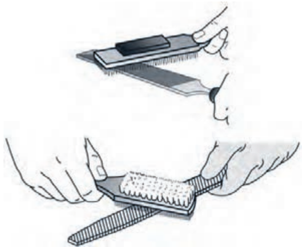
شکل ۱۱-۲۹ تمیز کردن سوهان با برس.
