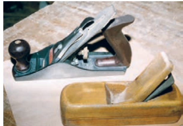
شکل ۶-۱- رنده‌ی چوبی و فلزی.
