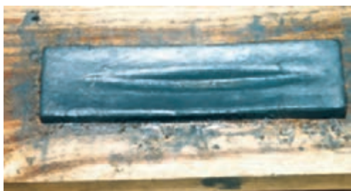
شکل ۱۴-۴- استفاده‌ی نادرست از سنگ نفت.
