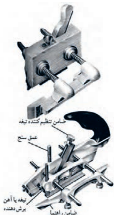
شکل ۶-۳۹ قسمت‌های مختلف رنده کنشکاف.
