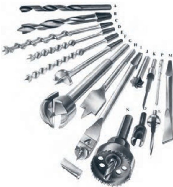
شکل ۱۲-۱۱- انواعی از سر مته‌های مخصوص چوب.
