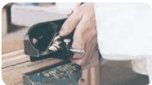
شکل ۶-۷۸. به کارگیری رنده بغل قابل تنظیم.
